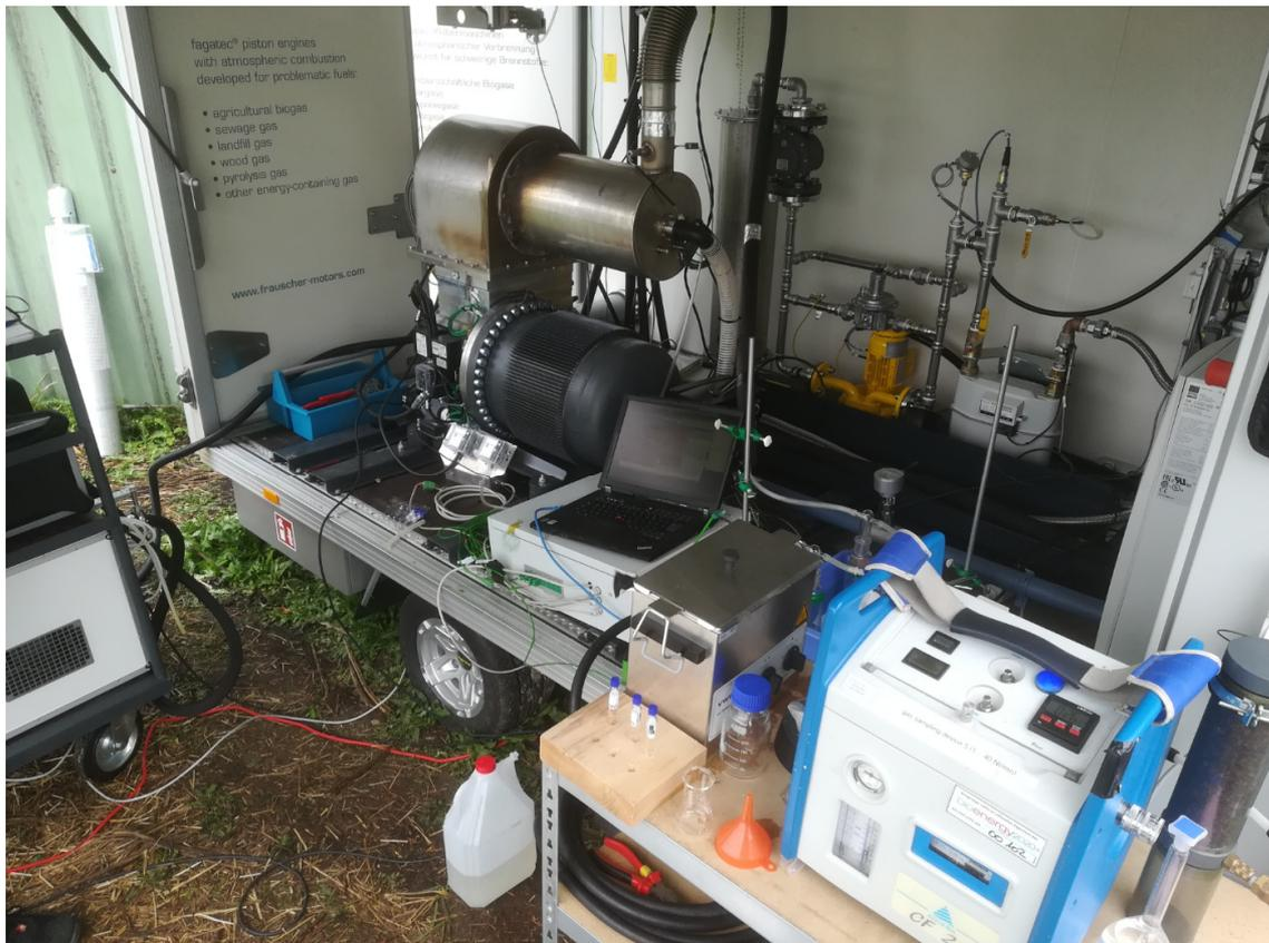
Abbildung 2: Messaufbau inkl. dem Stirling-BHKW im Trailer
