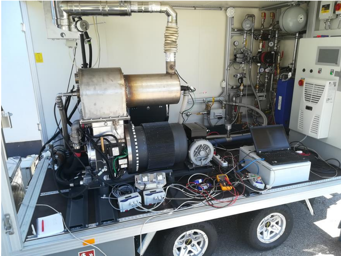
Abbildung 2: Messaufbau inkl. dem Stirling-BHKW im Trailer
