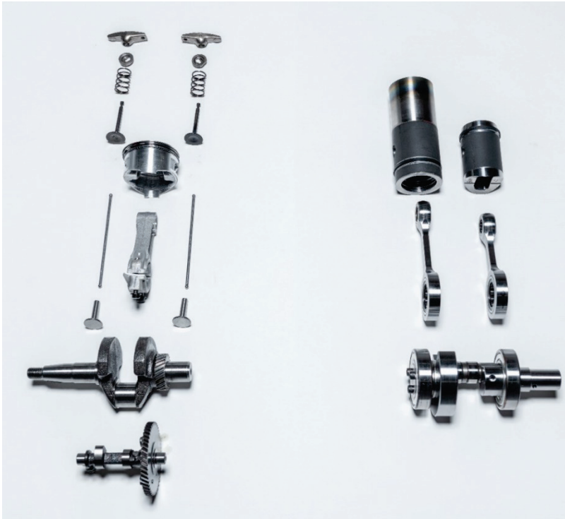
Abb. 12: Vergleich Anzahl bewegter Teile Ottomotor (16): alphagamma® Stirlingmotor (5)
