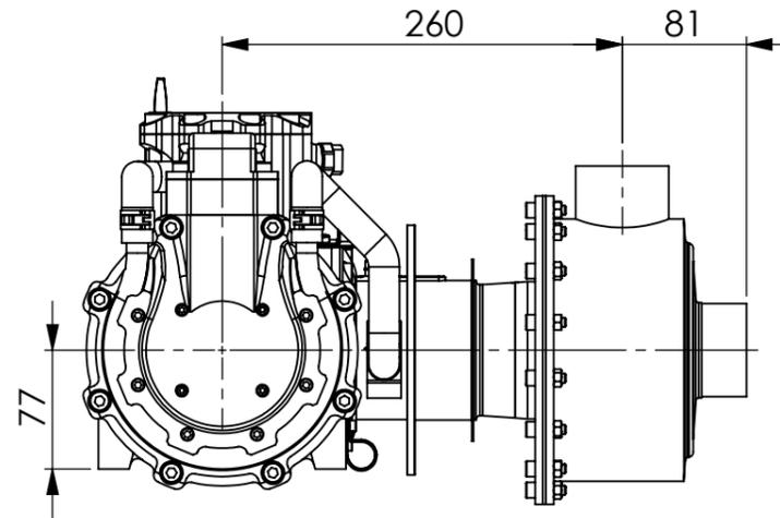
Austritt Wärmetauscher  $\varnothing 60,3 \times 2,5$
