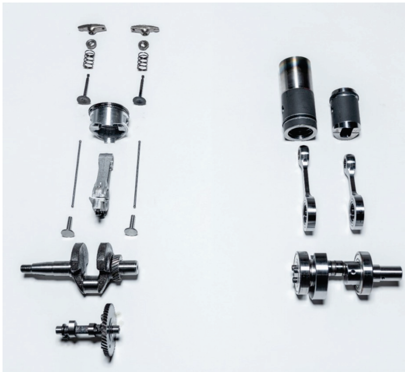
Abb. 12: Vergleich Anzahl bewegter Teile Ottomotor (16): alphagamma® Stirlingmotor (5)
